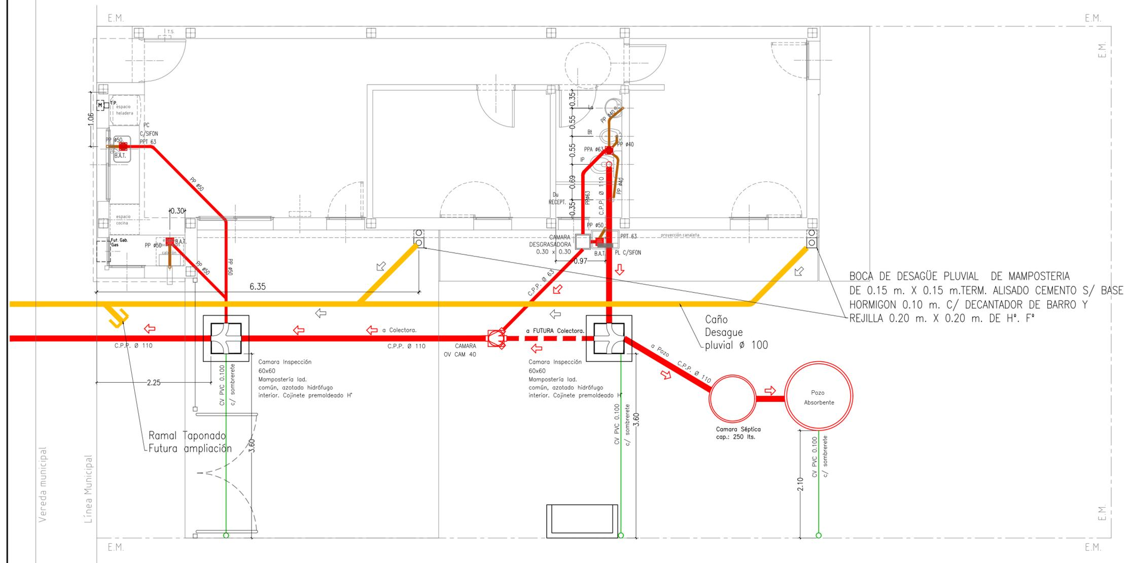
BOCA DE DESAGÜE PLUVIAL DE MAMPOSTERIA DE 0.15 m. X 0.15 m. TERM. ALISADO CEMENTO S/ BASE HORMIGON 0.10 m. C/ DECANTADOR DE BARRO Y REJILLA 0.20 m. X 0.20 m. DE H°. F°
